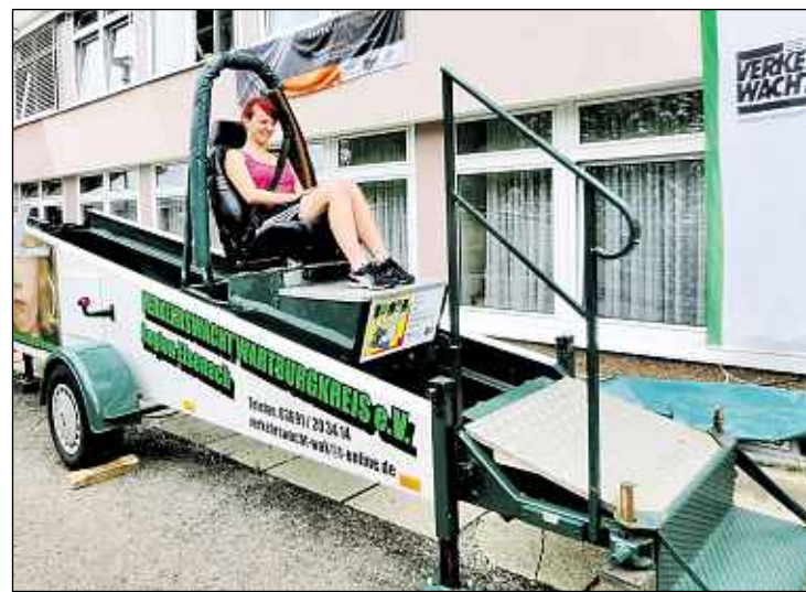
Im Gurtschlitten wird ein Aufprall auf ein vorausfahrendes Fahrzeug simuliert.
