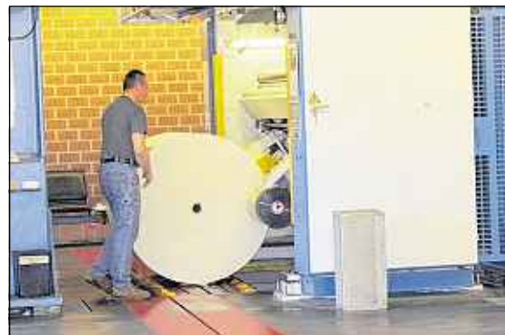
Ein Mitarbeiter wechselt eine Papierrolle. Mit einer Geschwindigkeit von 50 km/h bewegen sich die riesigen Rollen auf der Druckmaschine
