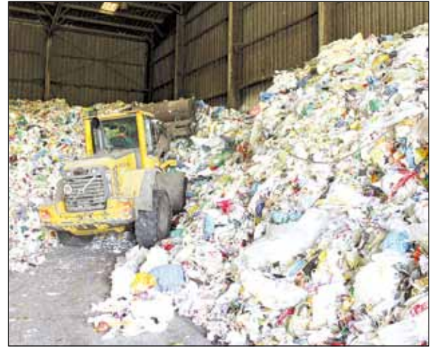
Mit Radladern werden die Müllsäcke immer wieder neu aufgetürmt, ehe sie dann in die Autosorts gehen
