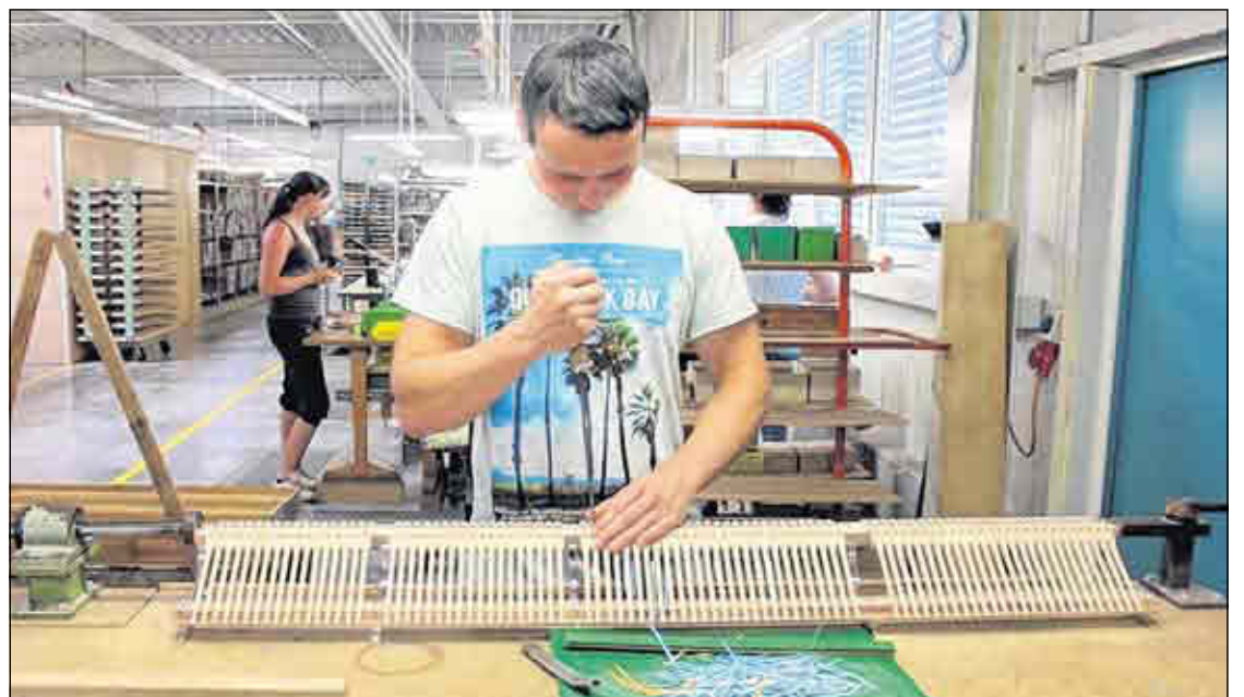
Mitarbeiter Maik Thurm justiert die Hammerstiele für eine Flügelmechanik. An diesen Bauteilen werden dann die Hammerköpfe montiert.
