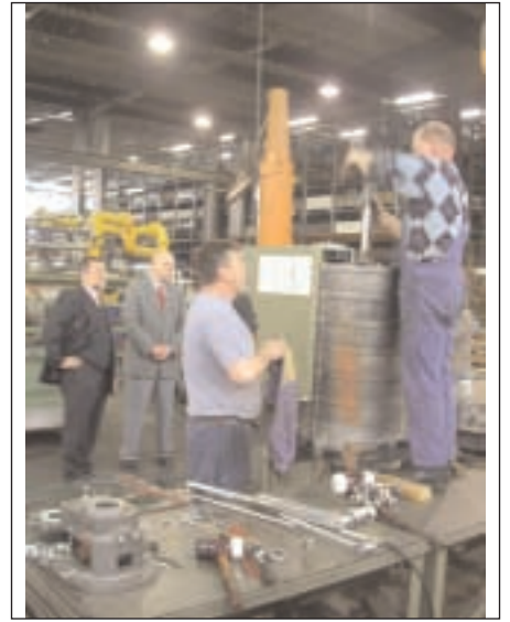
Alexander Radosaljevec und Franz Preiss (vorn im Bild) demonstrieren, wie die Pumpe auf die Welle gebracht wird.
