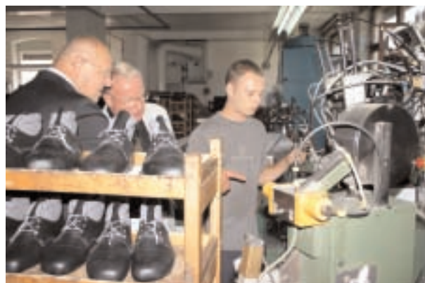
Rene Krause (rechts) an der Fersenwickmaschine
