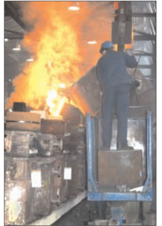
Die flüssige Schmelze ist über 1300 Grad heiß, wenn sie in die Formen gegossen wird.
